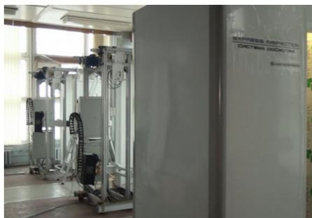
СРК является современной микродозовой цифровой рентгенографической установкой, принцип действия которой основан на сканировании человека узким плоским пучком рентгеновского излучения (ширина 0,6 мм) с последующей регистрацией детектором теневого рентгеновского изображения и выдачей его в цифровой форме на экран монитора для просмотра и анализа.
